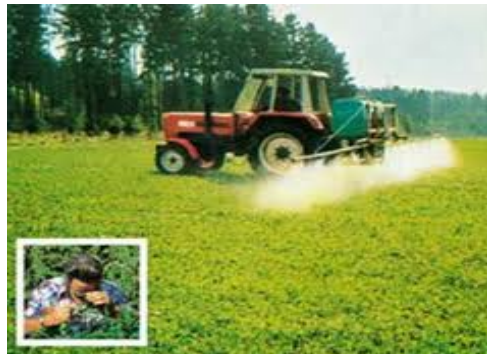
تراکتور با اتاقک سرنشین در برابر عوامل شیمیایی محافظت شده است
